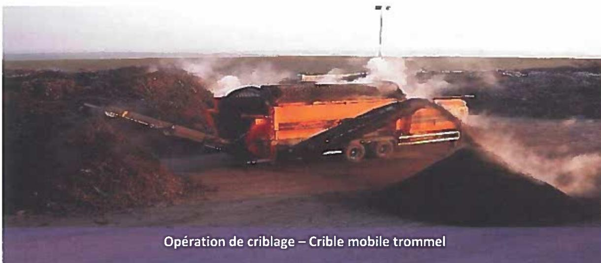
Opération de criblage – Crible mobile trommel
